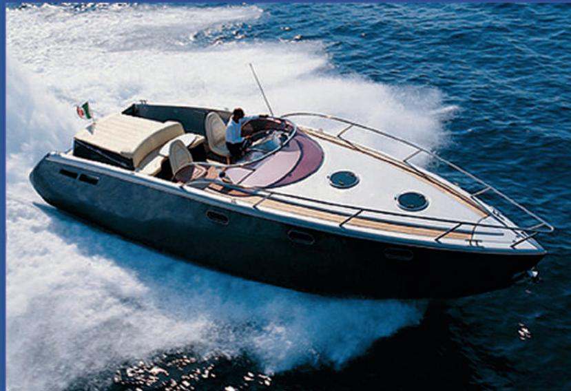
La barca ha una coperta con ampio prendisole a poppa, nel cui vano sottostante può essere alloggiato il tender con la possibilità di accedere alla sala motori.
